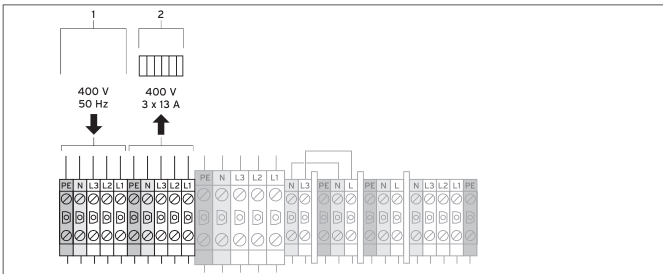
Мал. 7.11 Підключення зовнішнього додаткового електричного нагріву (опціонально) VWW
